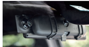
装着は純正ミラーに付属のバンドで留める。右側カメラ仕様だがあらゆる車種に対応可能だ。
