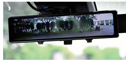
指で画面を上下スワイプすると映像の表示エリアを調整できる。左右スワイプで画面輝度の調整が可能。
