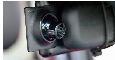
フロントカメラはスライド式で大型のミラーにも対応可能。また上下左右の微調整もできる。
