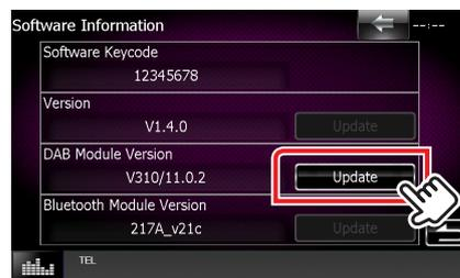
**Achtung:** Möglicherweise bleibt der Bildschirm einige Sekunden lang leer. Trennen Sie niemals das USB-Speichermedium oder die Stromversorgung des Geräts während des Update-Prozesses.
